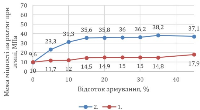
Рис. 7. Залежність межі міцності при згинанні композицій на основі портландцементу та армуючого компонента Ст2 від відсотка армування відразу після тепловологої обробки (2) та після автоклавування (1)
