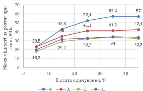
Рис. 10. Залежність межі міцності при згинанні композицій на основі портландцементу та армуючого компонента Ст1 (4) і Ст2 (3) та на основі гіпсоглиноземистого цементу та армуючого компонента Ст1 (2) і Ст2 (1) від відсотка армування після їх твердіння у воді протягом 360 діб.
