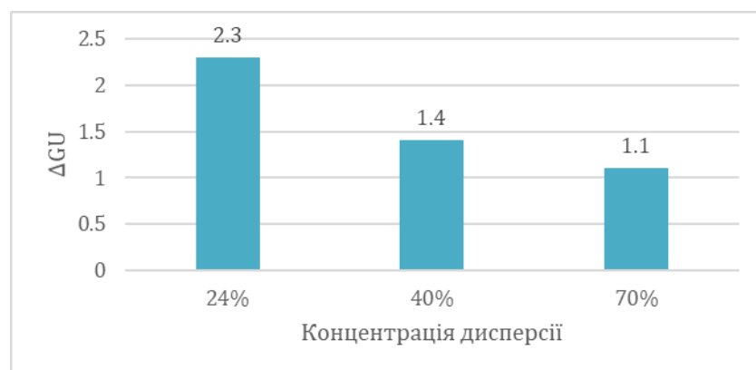
Рис. 2. Залежність зменшення блиску від концентрації при впливі УФ-світла
