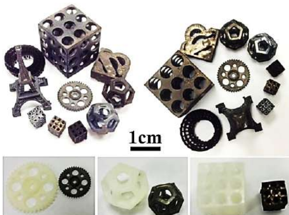
Рисунок 2 – Деталі на основі SiC, виготовлені за SL технологіями (зверху – 3D-друк, знизу – виготовлені методом напівсухого пресування і випалені) [2]
