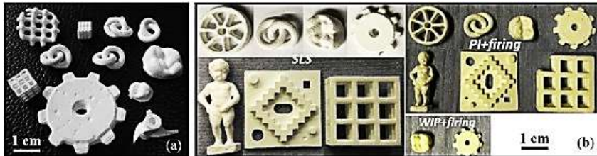
Рисунок 9 – Складні керамічні деталі, виготовлені методом SLS: (a) деталі з \text{Al}_2\text{O}_3 за допомогою квазіізостатичного пресування та остаточного випалу; (b) частини 3YSZ після SLS і після поєднання з інфільтрацією під тиском/теплим ізостатичним пресуванням і остаточним випалом [2]
