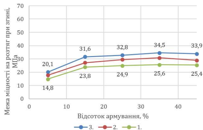
Рисунок 9 – Залежність межі міцності при згинанні композицій на основі гіпсоглиноземистого цементу та армуючого компонента Ст2 від відсотка армування після їх твердіння в гідрозатворі протягом 7 (1), 28 (2) та 360 (3) діб.
