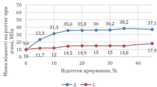
Рисунок 7 – Залежність межі міцності при згинанні композицій на основі портландцементу та армуючого компонента Ст2 від відсотка армування відразу після тепловологої обробки (2) та після автоклавування (1)
