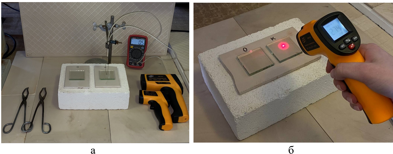
Рис. 1. Дослідження температури поверхні зразків: а – контактним (кондуктивним) методом; б – безконтактним (пірометричним) методом
